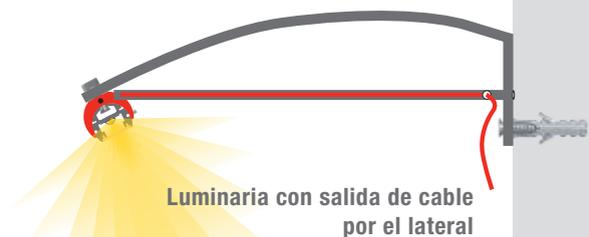
Luminaria con salida de cable por el lateral
